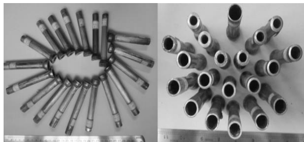
شکل ۵ پ) تصویری واقعی از نمونه‌های دو فلزی اکستروژن شده در شرایط متفاوت آزمایشگاهی.
