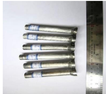
شکل ۳ ب) نمای واقعی از نمونه‌های دو فلزی اکستروژن شده در شرایط متفاوت آزمایشگاهی.
