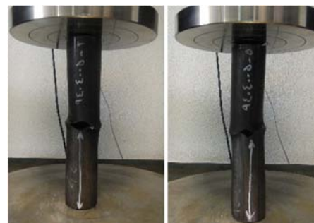
Fig. 5 figure of (5-2-C 125) and (5-5-L 125), after buckling شکل 5 شکل نمونه‌های (5-2-C 125) و (5-5-L 125)، بعد از کمانش
