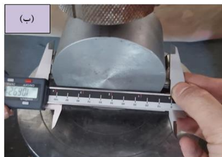
شکل ۲) الف) نمایش دستگاه و تجهیزات آزمایش تجربی و قالب و ورق در حین خم کاری ب) روش اندازه‌گیری ابعاد قطعه در انتهای خمکاری
