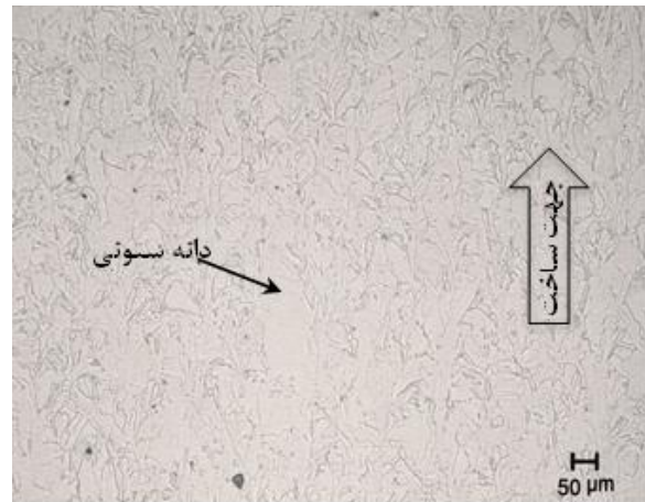
شکل ۶) تصویر میکروسکوپ نوری فلز پایه اینکونل ۷۱۸ ساخته شده به روش ذوب لیزر انتخابی
