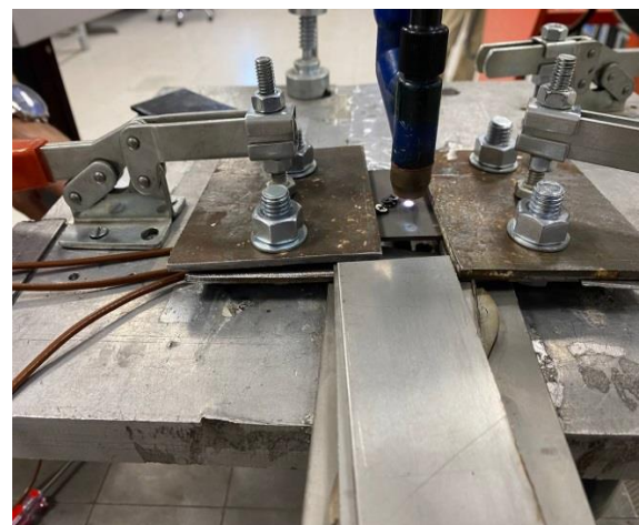
شکل ۱) نمایی از جوشکاری قطعه با استفاده از دستگاه جوش قوس پلازما و قید و بندهای استفاده شده
