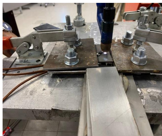
شکل ۱) نمایی از جوشکاری قطعه با استفاده از دستگاه جوش قوس پلازما و قید و بندهای استفاده شده
