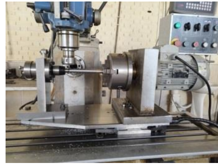
شکل ۳) نحوه اتصال مکانیزم تراش ساخته شده بر روی میز فرز
