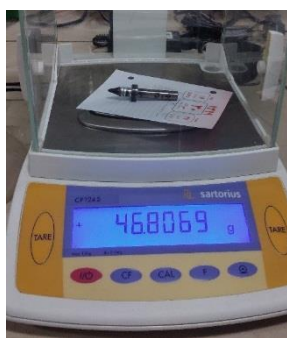
شکل (۵) اندازه‌گیری وزن مته‌ها با ترازوی حساس
