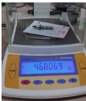
شکل (۵) اندازه‌گیری وزن مته‌ها با ترازوی حساس
