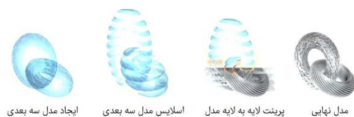
شکل ۱) مراحل فرآیند طراحی و تولید افزایشی
