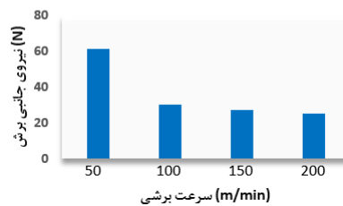
شکل ۸: تاثیر سرعت برشی بر نیروهای ماشینکاری
