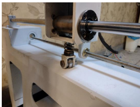
شکل ۳) فنر استفاده شده در سیستم متعادل کننده
