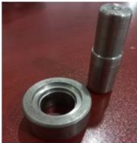
شکل ۵ (الف) دستگاه آزمایش اونیورسال (DMG) جهت انجام آزمایش حلقه (ب) قالب ساخته شده.
