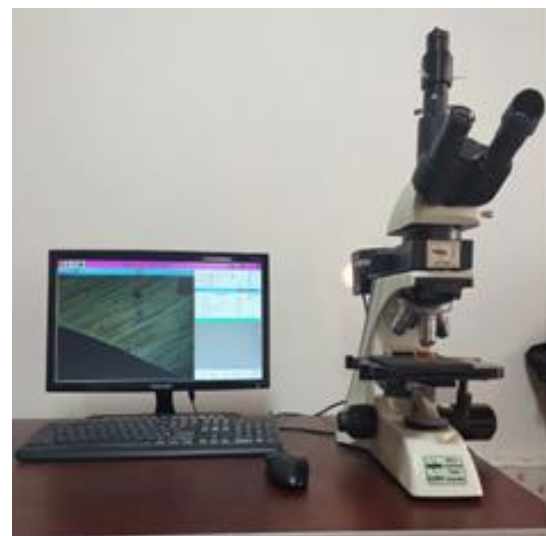
شکل ۷ دستگاه سختی‌سنجی میکرو ویکرز مدل MH3.
