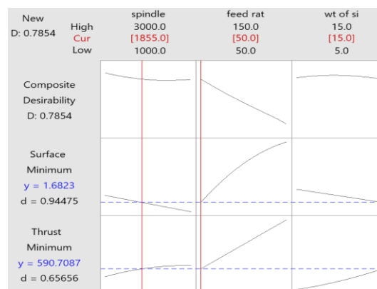
شکل ۱۲) بهینه‌سازی صورت گرفته به منظور الف) کمترین مقدار زبری سطح ب) کمترین مقدار نیروی محوری
