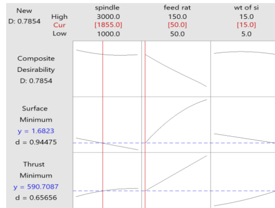
شکل ۱۲) بهینه‌سازی صورت گرفته به منظور الف) کمترین مقدار زبری سطح ب) کمترین مقدار نیروی محوری
