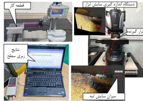
شکل (۲) تجهیزات استفاده شده جهت اندازه‌گیری زبری سطح و سایش لبه [۱۸]
