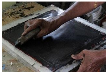
شکل ۱. کامپوزیت پلیمری تقویت شده با فیبر کربن پر شده با نانولوله کربنی
