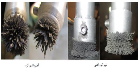
شکل ۸) نحوه تشکیل جاروبک ساینده
