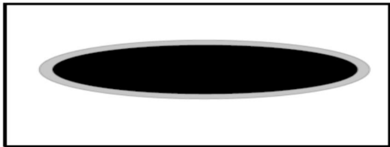
شکل 1 توزیع میکروذرات احاطه شده با فاز میانی در زمینه
