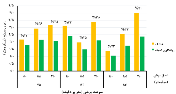
شکل ۲) نمودار زبری سطح بر اساس عمق برش، حالت روانکاری و سرعت برشی
