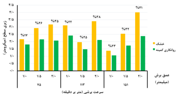
شکل ۲) نمودار زبری سطح بر اساس عمق برش، حالت روانکاری و سرعت برشی
