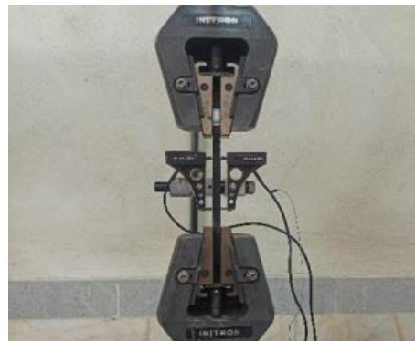
شکل ۳) دستگاه تست کشش نمونه‌های استاندارد
