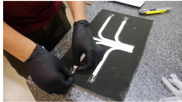
شکل ۴) شبکه لوله‌های حرارتی در داخل هسته لانه زنبوری
