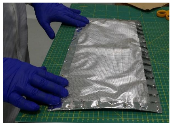
شکل ۶) نارسانای حرارتی چندلایه
