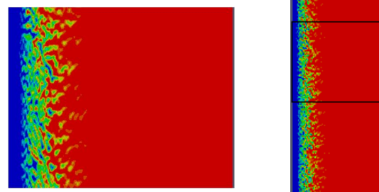
ب: نتایج مدل‌سازی (توزیع حجم کسری) ج: بزرگنمایی نتایج قسمت ب شکل 4 جریان فیلم میعان بر روی سطح قائم
