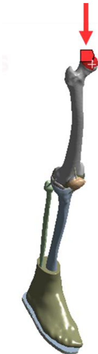
شکل ۵) نمایی از نحوه بارگذاری در محیط نرم افزار انسیس
