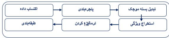
شکل ۳) فرایند آنالیز و تشخیص خطا چرخ‌دنده پلیمری
