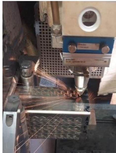
شکل ۴) ایجاد سلول‌های نیمه درون‌رو بر روی لوله جدار نازک معمولی توسط ماشین برش لیزر دوار
