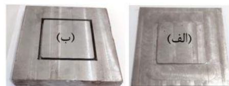
شکل ۶) نمایی از تکیه‌گاه تولید شده برای لوله‌های جدار نازک مشبک، (الف) تکیه‌گاه بالایی و (ب) تکیه‌گاه پایینی
