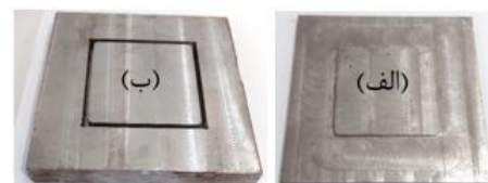
شکل ۶) نمایی از تکیه‌گاه تولید شده برای لوله‌های جدار نازک مشبک، (الف) تکیه‌گاه بالایی و (ب) تکیه‌گاه پایینی
