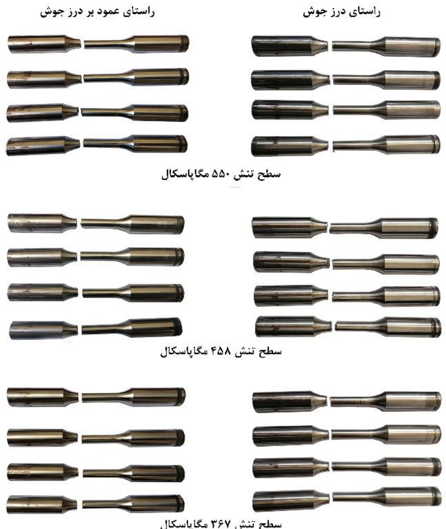
شکل ۳) نمونه‌های آزمایش شده فلز پایه لوله فولادی API X65 در سطوح مختلف تنش ناحیه عمر خستگی محدود.
