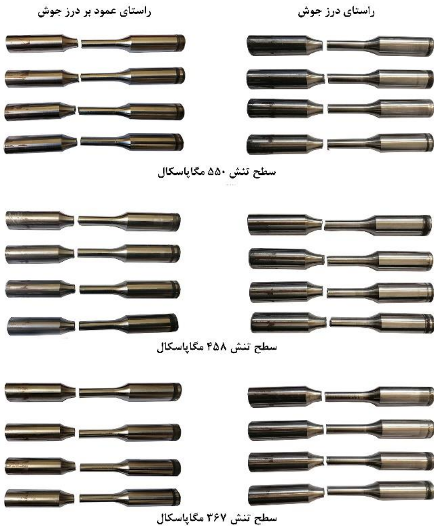
شکل ۳) نمونه‌های آزمایش شده فلز پایه لوله فولادی API X65 در سطوح مختلف تنش ناحیه عمر خستگی محدود.
