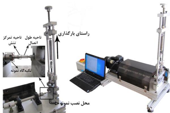
شکل ۲) دستگاه آزمایش خستگی خمشی- چرخشی معکوس شونده برای آزمایش نمونه یکسرگردار[4].
