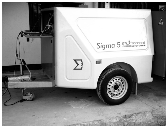
شکل ۱ دینامومتر Σ5 NJ- FROMENT برای اندازه گیری پارامترهای تراکتور
