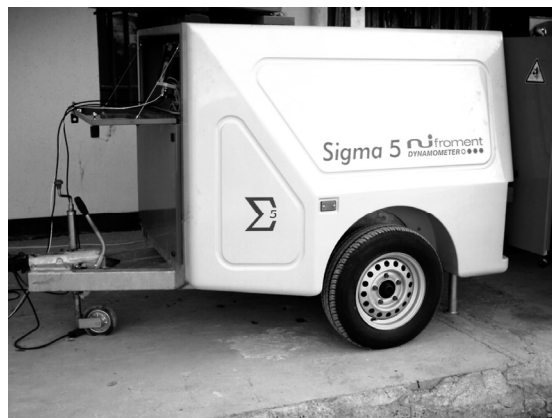
شکل ۱ دینامومتر Σ5 NJ- FROMENT برای اندازه گیری پارامترهای تراکتور
