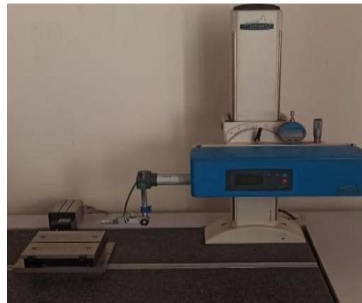
شکل ۳) دستگاه زبری سنج (Hommlerwerke T8000 ساخت آلمان)
