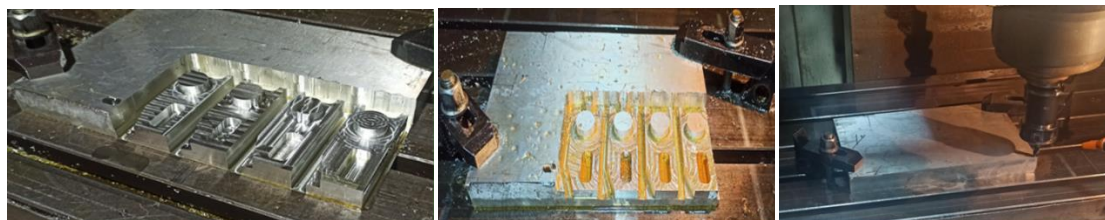
شکل ۲) الف) تصویر بلوک خام آلومینیوم T6 قبل از عملیات خشن‌کاری (ب) تصویر واقعی بلوک بعد از پایان عملیات خشن‌کاری (ج) تصویر پایان عملیات پرداخت بلوک آلومینیومی با استراتژی‌های مختلف
