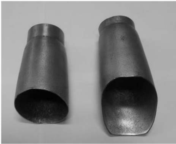
Fig. 9 produced bulged and rectangular sample by reconfigurable die شکل 9 لوله متورم شده و لوله با سطح مقطع مربعی تولید شده به وسیله قالب انعطاف پذیر
