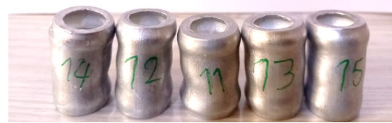
شکل ۱۰) تغییر شکل هسته‌های سازه پس از بارگذاری
