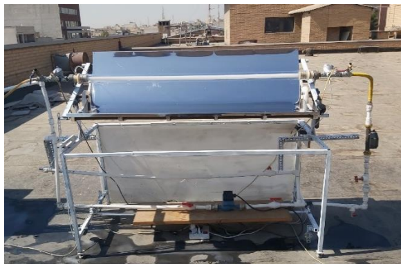
شکل (۴) سیستم آزمون عملکرد کلکتور خورشیدی ساخته شده
