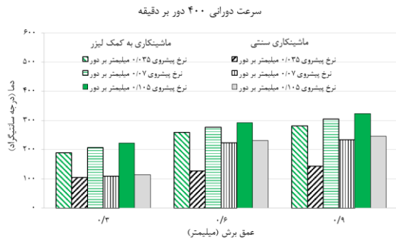
شکل ۵) مقایسه تاثیر مقادیر متفاوت نرخ پیشروی و عمق برش بر دمای براده در تراشکاری سنتی و تراشکاری به کمک لیزر
