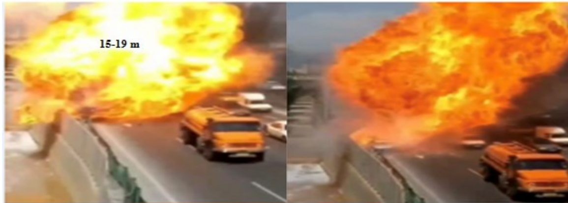
شکل ۶) انفجار مخزن با شدت تشعشع بالا و تشکیل گوی آتش
