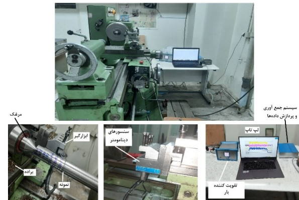
شکل ۳ تصاویر دستگاه تراشکاری مورد استفاده، تجهیزات اندازه‌گیری نیروی سه بعدی نیرو و نمونه قطعه‌کار در حال روتراشی
