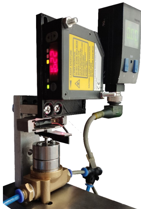
شکل ۴) شیر قطع و وصل پیزوالکتریک ساخته شده همراه با لیزر پاناسونیک در حال اندازه گیری جابجایی پلانجر
