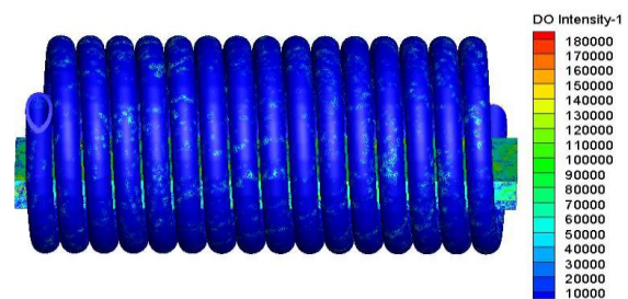
شکل ۱۶) کانتور شدت تشعشع بر روی لوله های مارپیچ و سرباره
