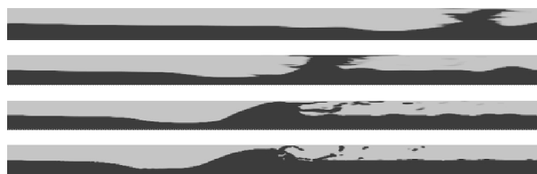
شکل ۳ بررسی استقلال حل از شبکه در راستای طول کانال (بالا به پایین: ۲۰۰، ۴۰۰، ۸۰۰ و ۱۶۰۰ شبکه در راستای طول کانال)
