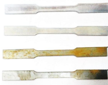
شکل 4 نمونه ورق‌های برش خورده توسط دستگاه وایر کات
