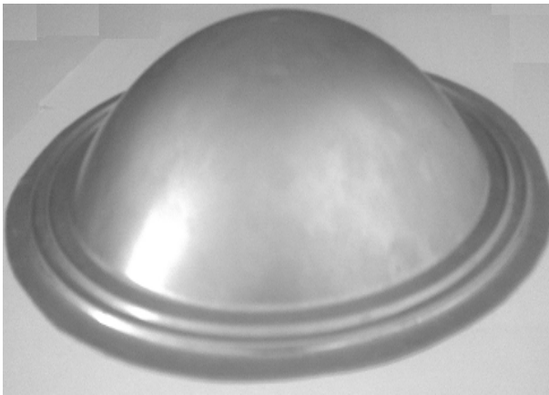
شکل ۴ ورق شکل گرفته در تست آزمایشگاهی
