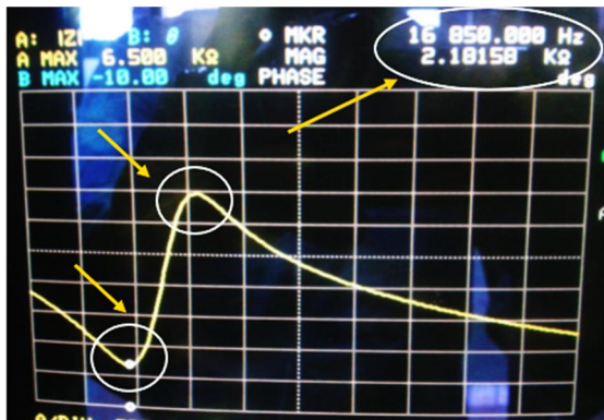
شکل 16 منحنی امپدانس الکتریکی برحسب فرکانس
