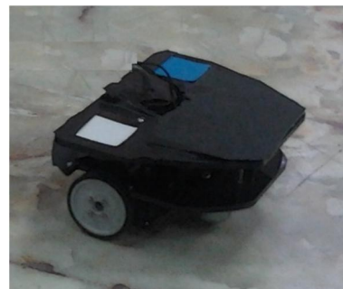
شکل 7 نمونه ساخته شده ربات متحرک چرخ دار
