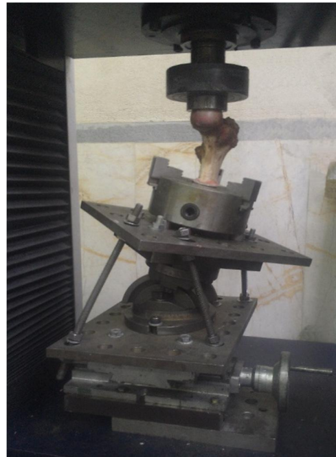
شکل 3 نمونه استخوان ران مقید شده در فیکسچر و تحت شرایط بارگذاری در دستگاه تست کشش-فشار
