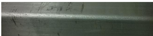
Fig. 27 Final form of the tube without cracks شکل 27 شکل نهایی لوله بدون ترک
