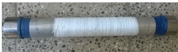
Fig. 25 The test result for tube filled with hydraulic oil using the three-piece die and teflon tape شکل 25 نتیجه آزمایش با روغن هیدرولیک با استفاده از قالب سه قطعه‌ای و نوار تفلون
