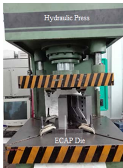
Fig. 4 Hydraulic press and ECAP die setup.
