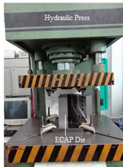
Fig. 4 Hydraulic press and ECAP die setup.
