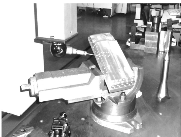
شکل 13 مرحله اندازه‌برداری نقاط توسط ماشین اندازه‌گیری مختصات در موقعیت انتقال داده شده
