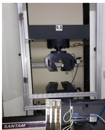
Fig. 7 Steel sheet tensile test
