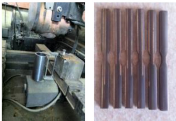
Fig. 3 View of the preparation of tensile test coupons شکل 3 نمای از ساخت نمونه‌های تست کشش
